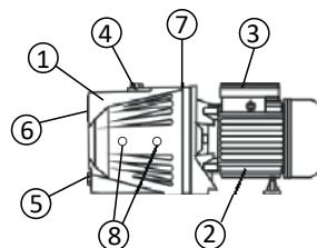
Насос состоит из следующих основных узлов: центробежного самовсасывающего насоса – (1), асинхронного электродвигателя – (2) и пускового устройства – (3). Насос имеет заливное – (4) и сливное – (5) отверстия, входное – (6) и выходное – (7) отверстия, а также отверстия для монтажа манометра и реле управления (8). На корпусе насоса расположена идентификационная табличка, на которой указаны основные характеристики насоса.
