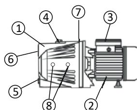
Насос складається з наступних основних вузлів: відцентрового самовсмоктуючого насоса - (1), асинхронного електродвигуна- (2) і пускового пристрою-(3). Насос має зливний - (4) і зливний - (5) отвори, входний - (6) і вихідний - (7) отвори, а також отвори для монтажу манометра і реле управління (8). На корпусі насоса розташована ідентифікаційна таблиця, на якій указані основні характеристики насосу.
