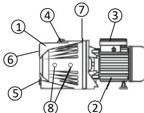
Pompa składa się z następujących podstawowych węzłów: odśrodkowej pompy ssącej- (1), asynchronicznego silnika elektrycznego-(2) urządzenia rozruchowego-(3). Pompa ma otwory zalewowy - (4) i zlewowy - (5) otwory, wejściowy - (6) i wyjściowy - (7), a także otwory do montażu manometru i przekaźnika sterowania (8). Na korpusie pompy znajduje się szyld identyfikacyjny, na którym podane są główne parametry pompy.
