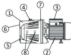
Pompa składa się z następujących podstawowych węzłów: odśrodkowej pompy ssącej - (1), asynchronicznego silnika elektrycznego - (2) urządzenia rozruchowego - (3). Pompa ma otwór zalewowy - (4) i zlewowy - (5) otwory, wejściowy - (6) i wyjściowy - (7), a także otwory do montażu manometru i przekaźnika sterowania (8). Na korpusie pompy znajduje się szyld identyfikacyjny, na którym podane są główne parametry pompy.
